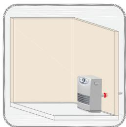
Instalación de calefactor a kerosene de tiro forzado que expulsa los gases de combustión al exterior de la vivienda. La potencia térmica nominal debe ser la adecuada a las condiciones de la viviendas (Clima y características propias de la vivienda).
