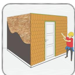
Muro existente conformado por una estructura de madera, al cual se le incorporan dos capas de Lana fibra de oveja: la primera instalada al interior del tabique y la segunda capa instalada sobre un listoneado exterior. Se considera como revestimiento de terminación tejuela de madera de Ciprés o madera de Lengua.
